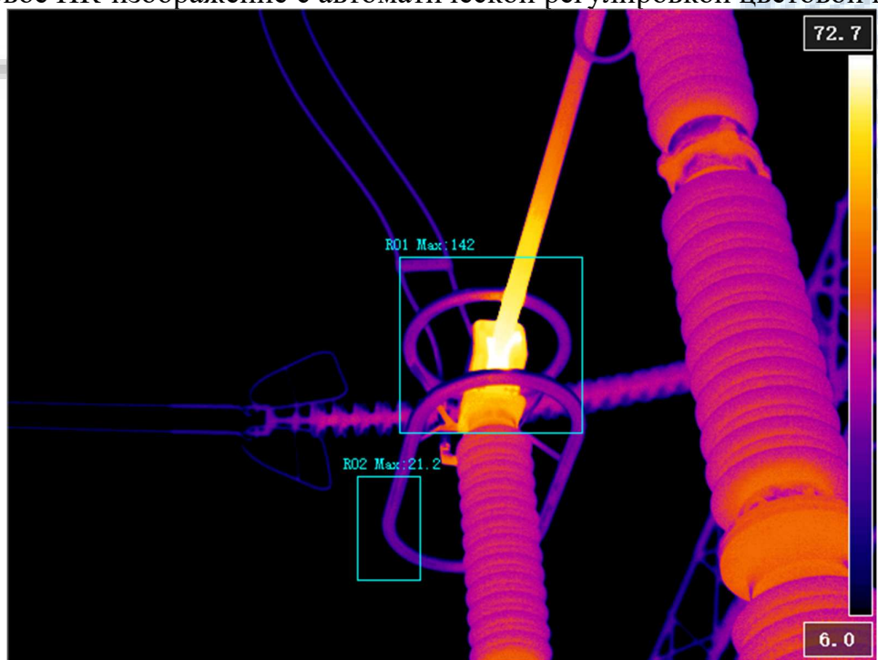
Тепловое ИК-изображение с ручной регулировкой цветовой шкалы
